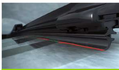
Torn blade Essuie-glace déchiré
